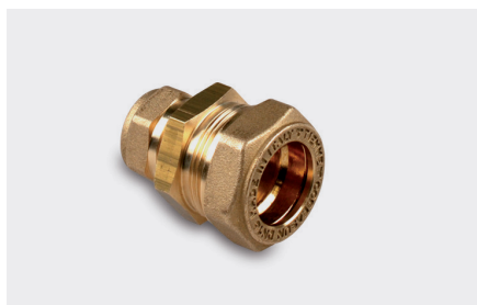
Montagekoppeling voor collectorleidingen Voor het aansluiten van de solar-spiraalbuis aan de zonnecollectoren RSK 25 (meegeleverd bij spiraalbuismontageset)
